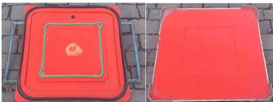
Figura 1- Molde utilizado para confecção das placas por RTM
