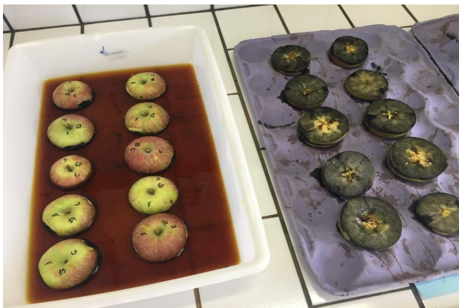
Figura 6. Teste de Iodo-Amido para determinar o Índice de Regressão do Amido (IRA) em maçãs.
