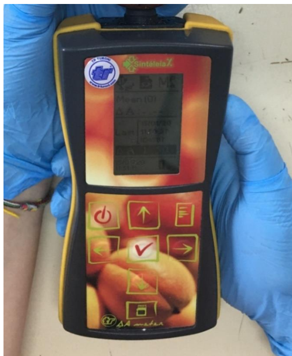
Figura 4. Uso do equipamento portátil DA-Meter para medir o índice do teor de clorofila na epiderme de maçãs.
