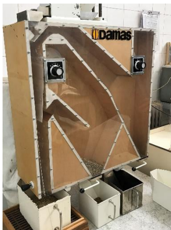
Figura 12 - Separador de ar para sementes (DAMAS®)
