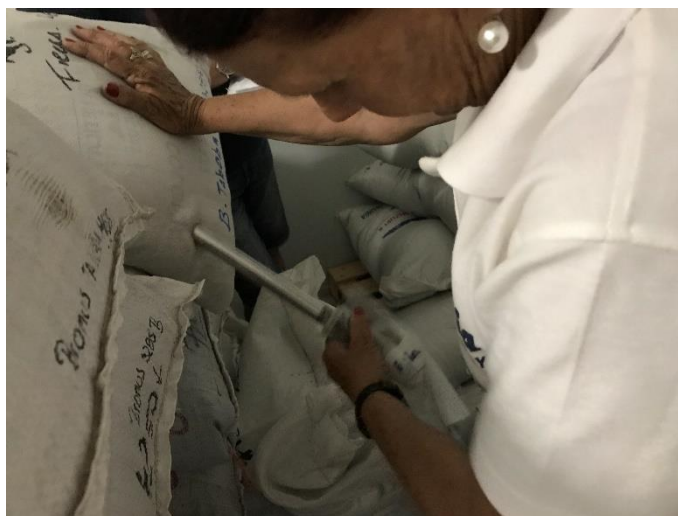
Figura 8 - Amostragem com calador em sacarias de sementes forrageiras.
