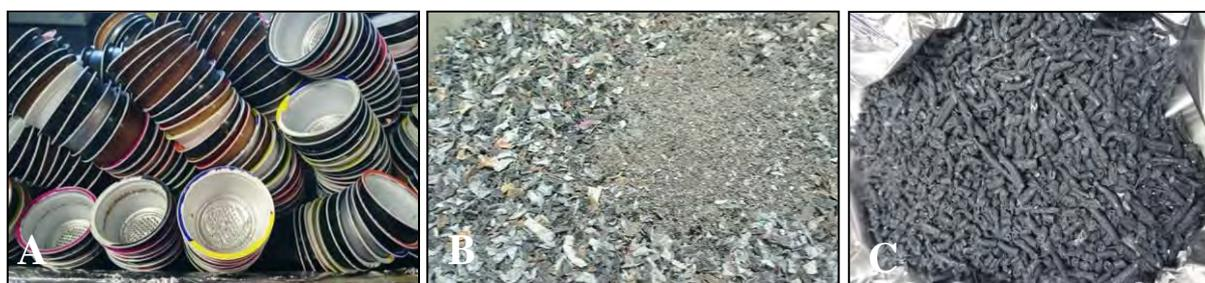
Figura 1 - Cápsulas de café utilizadas neste trabalho: cápsulas plásticas (A), após moagem (B) e grânulos após processo de extrusão (C).
