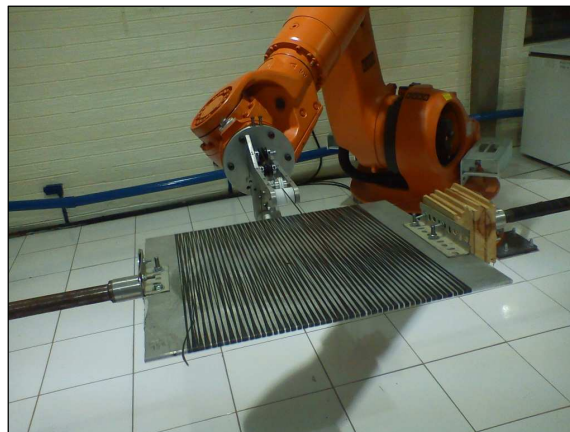
Figura 2 – Fabricação dos laminados estudados por filament winding , pela vertente dry-winding .
