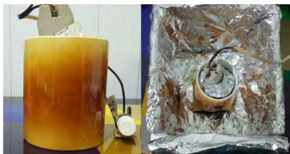
Figura 1: À esquerda o esquema de aquecimento lâmpada incandescente, caneca e dimer. À direita, o anteparo de confinamento.
