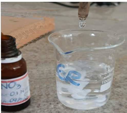
Figura 63: Solução de nitrato de prata reage com o cloreto remanescente na água de lavagem.
