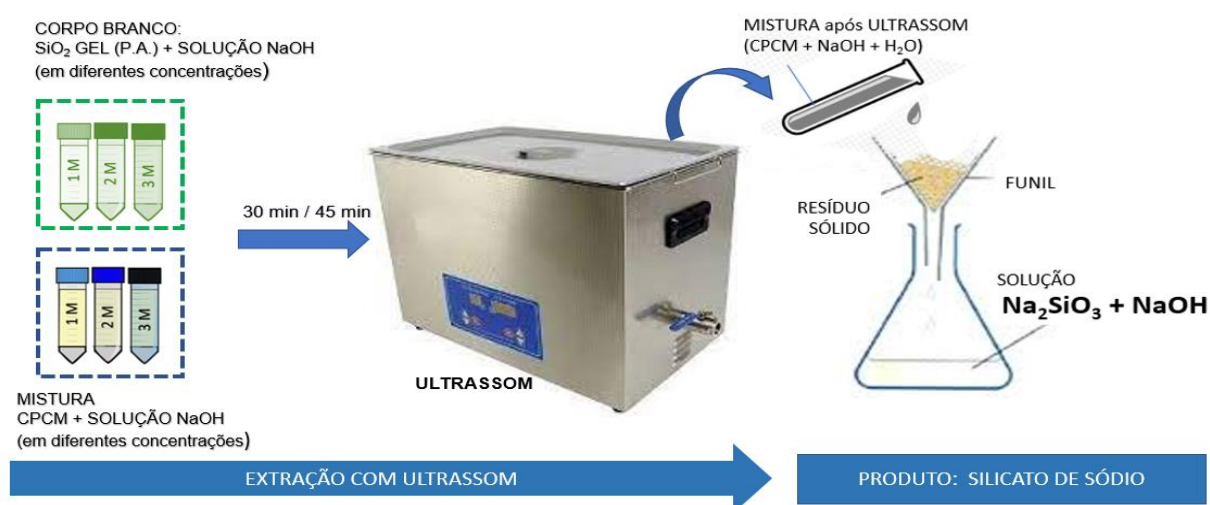
Figura 58: Processo de extração por ultrassom (Método 03)
