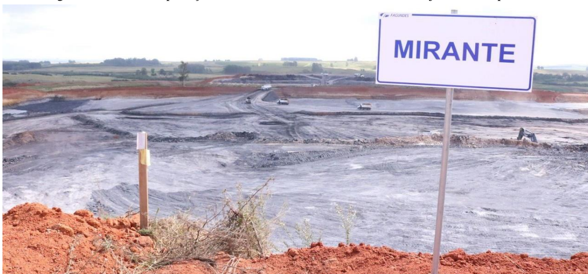
Figura 17: Cava de exploração de carvão na Mina Candiota onde os rejeitos são depositados
