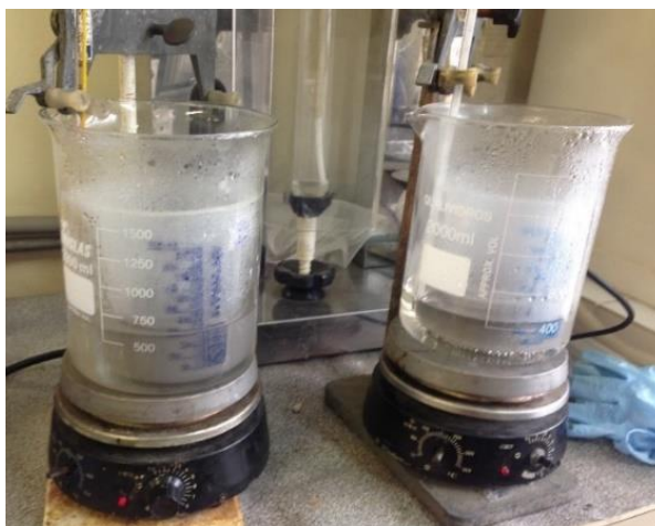
Figura 53: Método 01 - extração em banho-maria e agitador magnético com aquecimento
