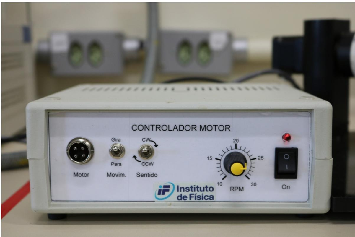
Figura 9 – Controlador do motor
