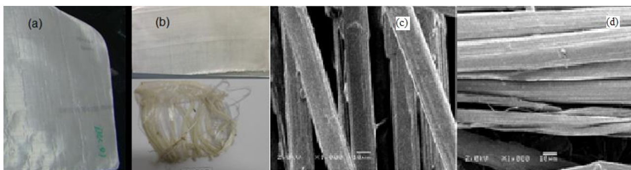
Figura 4 – Imagem de lâmina PEUAM (a), da fibra envelhecida (b), micrografia das amostras de Dyn04u (c) e Dyn07n (d)
