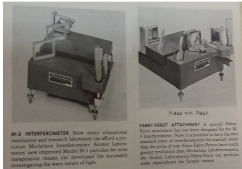
Figura 9 - M-3 Interferômetro de Michelson (1) e com Fabry-Perot (2) Fonte: 1º Catálogo Cenco (Acervo do Laboratório de Ensino de Física). Foto: Kimberly Pires, Ana Carolina Gelmini, 2017
