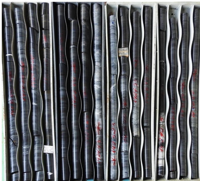
Figura 15: Parte do intervalo selecionado para descrição do furo CPIVESD0015A. Nota-se a presença de veios de quartzo branco entre os metassedimentos. AngloGold Ashanti (2019).
