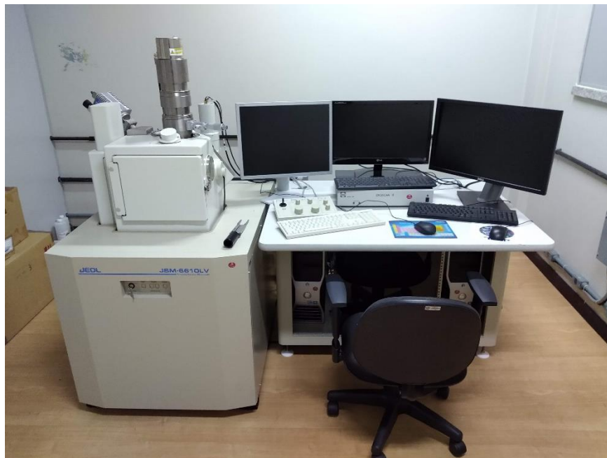
Figura 20: Microscópio eletrônico de varredura JEOL utilizado neste trabalho. LGI - IGEO - UFRGS. Dados da pesquisa, 2019.
