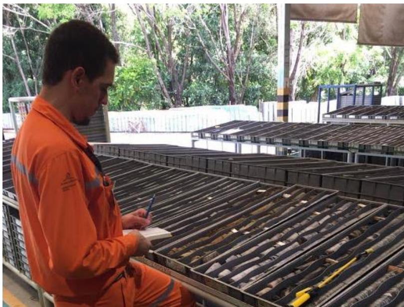
Figura 14: Processo de descrição macroscópica dos testemunhos de sondagem. Dados da pesquisa, 2019.
