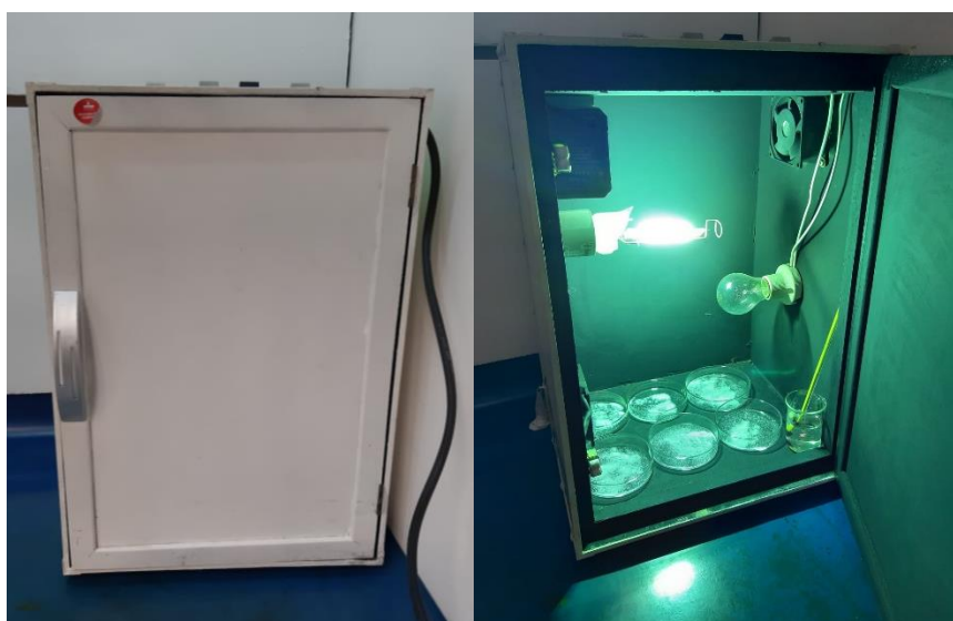
Figura 7: Imagens da câmara de envelhecimento.
