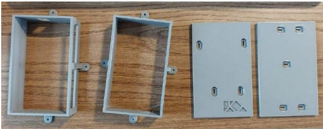
Figura 24 – Foto das peças impressas da caixa.
