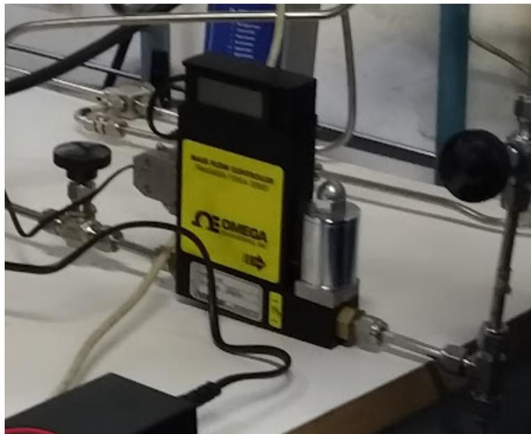
Figura 5 – Foto do controlador de fluxo utilizado no LASIS.
