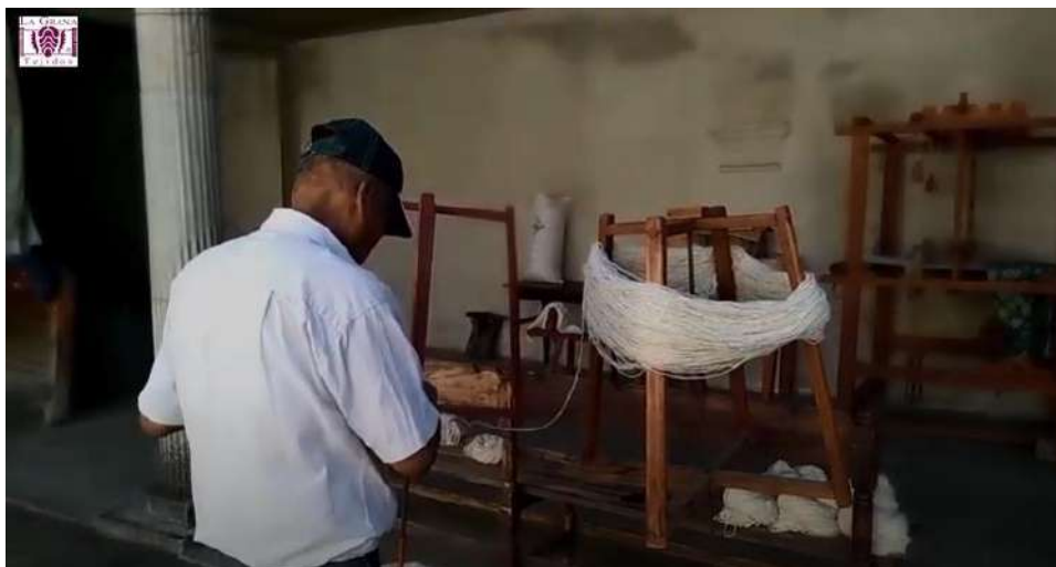
Artesão fazendo novelo em uma enroladora de fios construída em madeira. Frame do vídeo Devanadera artesanal de hilo , publicado pelo canal do Youtube Tejidos Artesanales La Grana . 8
