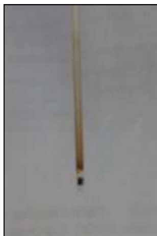
Figura 4.6 - Capilar após análise de faixa de fusão para a amostra 3-OBB, indicando degradação da amostra.
