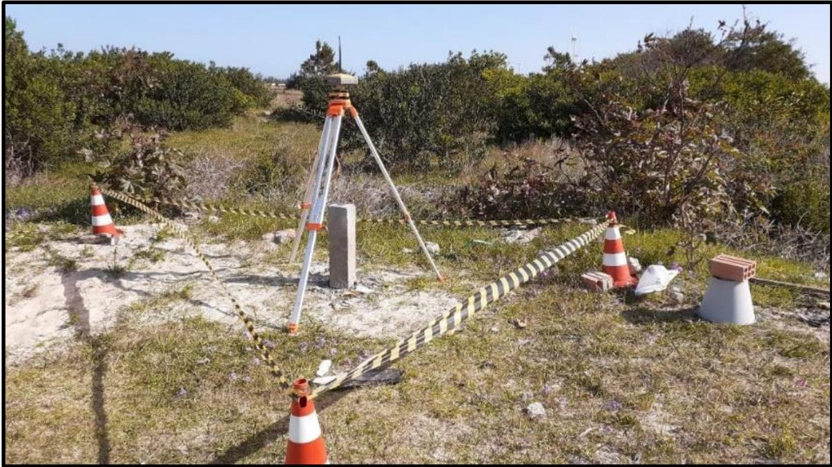
*Figura 29 – GNSS coletando dados do marco M03*
