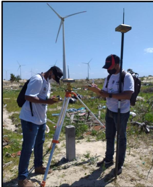
*Figura 18 – Instalação e configuração dos GNSS da Base e Rover*
