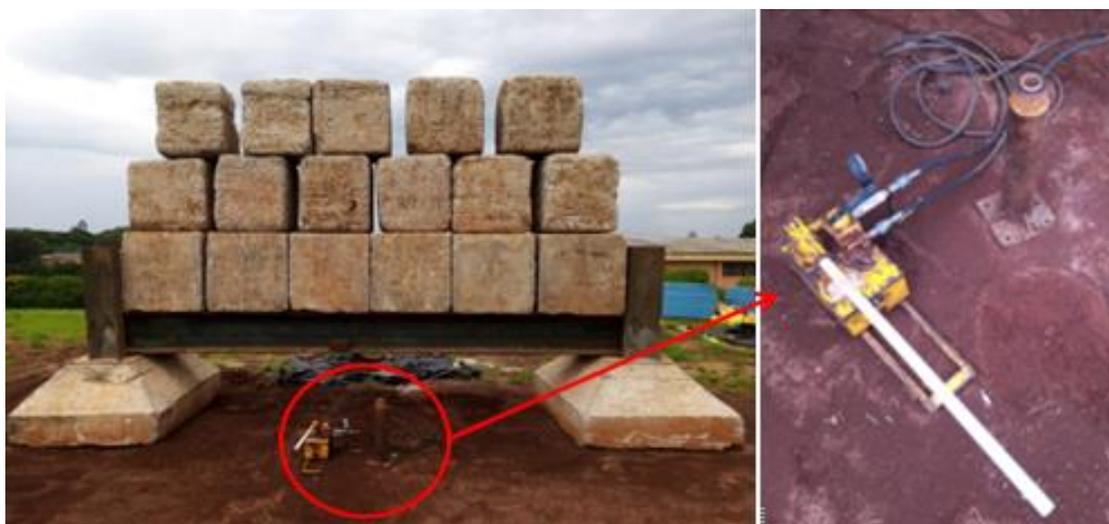
**Figura 129** – Sistema de pórtico de reação com detalhamento do macaco hidráulico. (Fonte: Própria, 2021)
