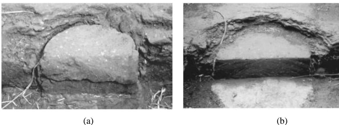
**Figura 49** – Superfícies de rupturas das camadas melhoradas: a)  $H_{cam}/D_{pl} = 0,25$ ; b)  $H_{cam}/D_{pl} = 0,50$ . (Fonte: Thomé, 1999)
