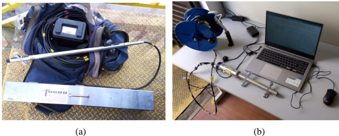
**Figura 213** – Estruturas das sondas inclinométricas utilizadas: a) *Digitilt Datamate II*; b) Sonda experimental proposta já acoplada no *notebook*. (Fonte: Própria, 2021)
