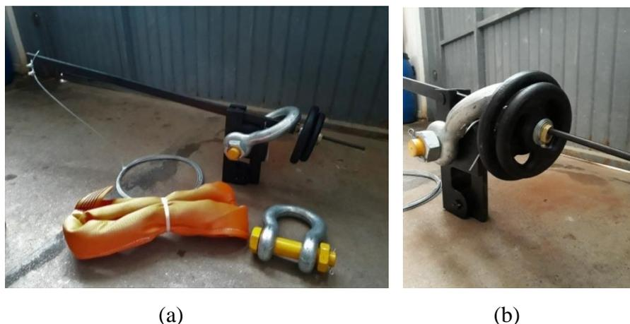
**Figura 111** – Conjuntos de liberação do martelo de compactação: a) vista do gatilho, laço e as manilhas; b) vista lateral do gatilho. (Fonte: Própria, 2019)
