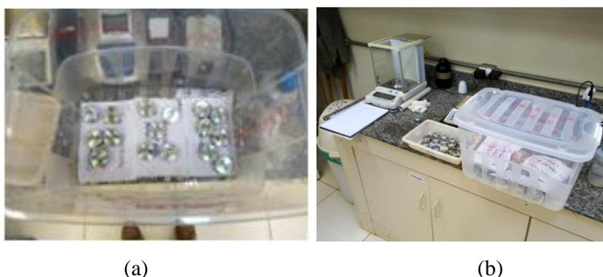
**Figura 134** – Ensaio de sucção: a) amostras de papel filtro separadas por camada; b) amostras sendo pesadas. (Fonte: Própria, 2021)
