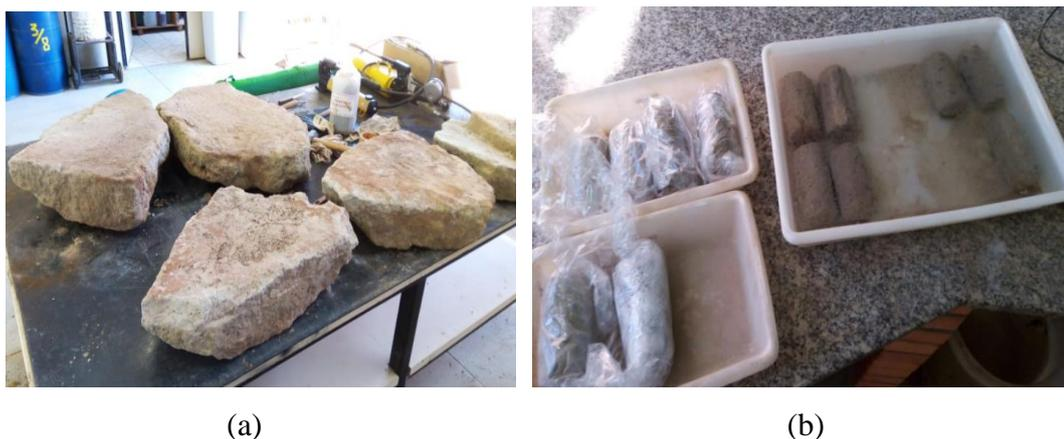
**Figura 135** – Extração de testemunhos da camada melhorada: a) material da camada melhorada de 150 mm rompida; b) corpos de prova embalados para ensaios triaxiais CID e corpos de prova em fase de saturação para ensaio de compressão não confinada. (Fonte: Própria, 2021)
