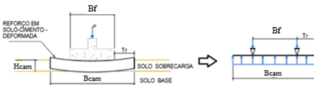
**Figura 58** – Analogia dos esforços da camada melhorada em função do modelo isostático de viga biapoiada. (Fonte: Foppa, 2016)
