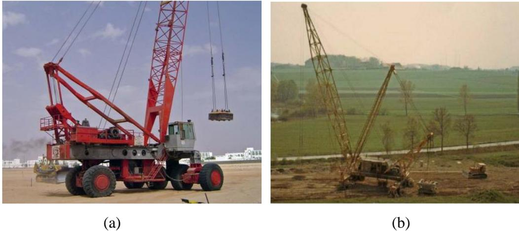
**Figura 33** – a) Equipamento de compactação dinâmica com energia de 7 MNm; b) Mega máquina compactação dinâmica com energia de 16 MNm. (Fonte: Hamidi, 2014)
