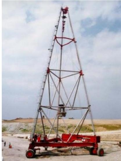
**Figura 32** – Tripé de Menard usado na compactação dinâmica. (Fonte: Hamidi, 2014)
