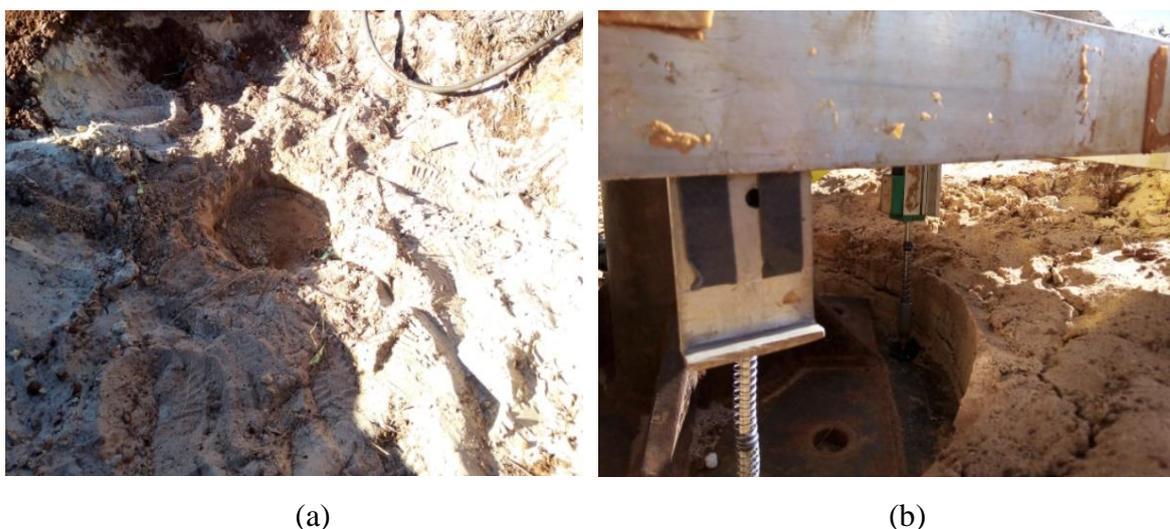
**Figura 171** – Ruptura do PE-III: a) Detalhe do afundamento da placa na superfície após o ensaio; b) Detalhe da formação da trinca ao entorno da placa após o ensaio. (Fonte: Própria, 2021)
