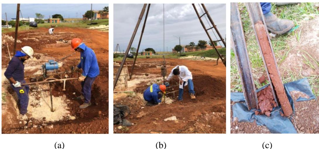
**Figura 138** – Procedimentos executivos do ensaio SPT nas colunas granulares: a) escavação do furo; b) introdução do amostrador na cota de ensaio; c) e material coletado pelo amostrador. (Fonte: Própria, 2021)
