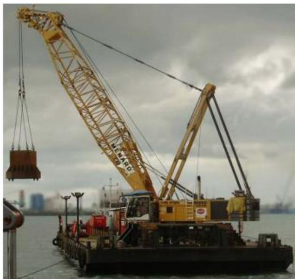
**Figura 37** – Equipamento de compactação dinâmica *offshore* em plataformas marítimas. (Fonte: Hamidi, 2014)
