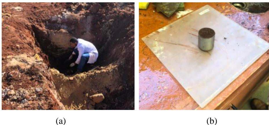
**Figura 139** – Coleta de amostra indeformada do solo laterítico de Passo Fundo/RS: a) coleta do material abaixo da coluna; b) material coletado. (Fonte: Própria, 2021)
