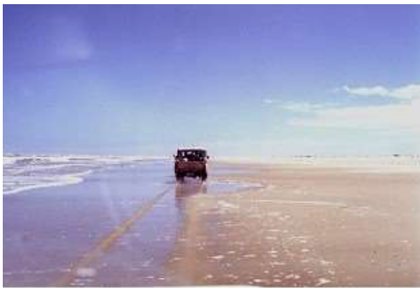
Fig. 3 - Levantamento da linha de praia com sistema de posicionamento global – GPS, fixado num veículo que se desloca ao longo da linha de água associada ao espraiamento da onda (TOLDO & ALMEIDA 2003).
