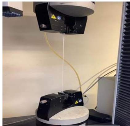
Figura 5. Dimensões da amostra em forma de haltere tipo 2 para o teste de resistência à tração em mm (A=75, B=12.5±1, C=25±1, D=12.5±1 e E=8±0.5) de acordo com a ISO 37 30 . À direita, a amostra sendo submetida ao teste de tração.
