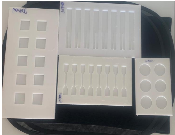
Figura 2. Matrizes de acrílico elaboradas de acordo com as dimensões exigidas pelas respectivas especificações para cada ensaio
