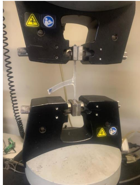
Figura 4. Dimensões da amostra de acordo com o teste de resistência ao rasgamento, forma retangular (calças) de acordo com a ISO 34-1 28 em mm (A=100, B=40±2, C=2±0.2, D=15±1, E=7.5±0.5 e F=direção da força). Ao lado a amostra sendo submetida ao teste de rasgamento.
