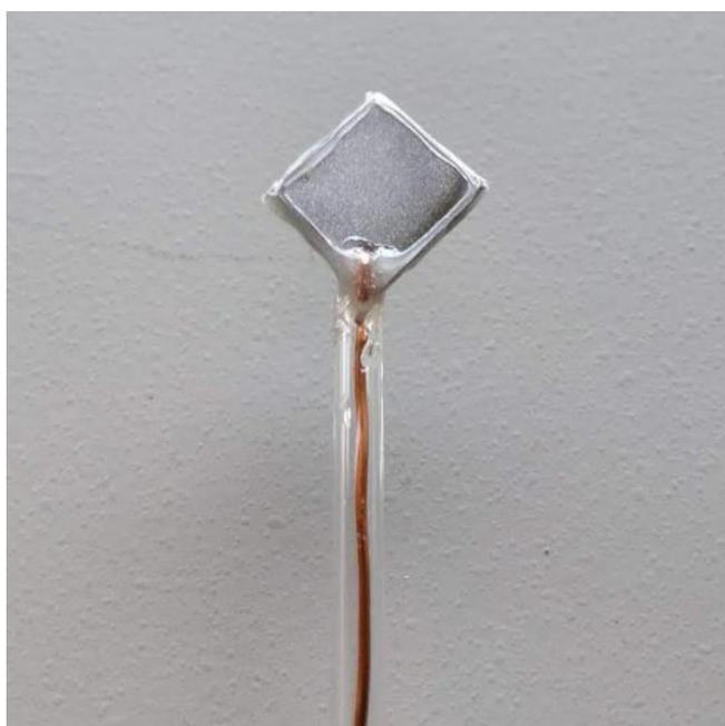
Figura 4.2. Amostra da liga AA2024 já montada.
