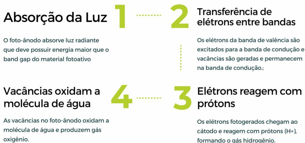
Figura 8:Descrições resumidas das etapas da produção de hidrogênio. Adaptado de [23].
