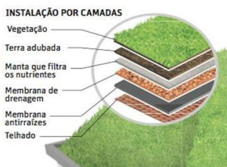
Figura 10: Representação Esquemática de um telhado verde. Fonte: Bioclimatismo, 2016
