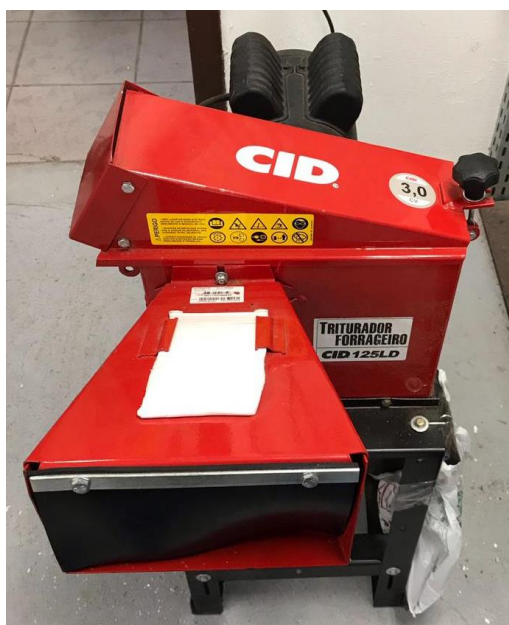
Figura 13: Triturador Forrageiro Picador CID125LD utilizado para moer o blister após processamento.
