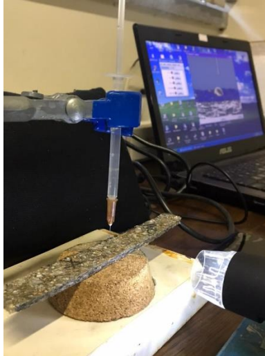
Figura 20: Sistema para o ensaio de ângulo de contato sendo realizado.
