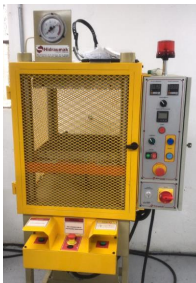
Figura 14: Prensa térmica Hidraumak utilizada para conformação das placas.
