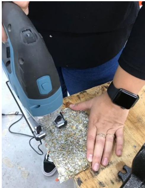
Figura 16: Obtenção dos corpos de prova através da utilização da Serra Wesco.
