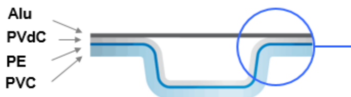
Figura 10: Representação de blister com multicamadas. (Perlen Packaging)
