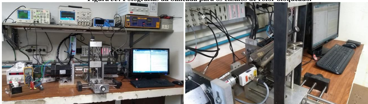
Figura 35: Fotografias da bancada para os ensaios de rotor bloqueado.
