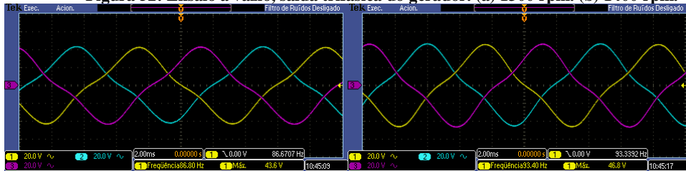
Figura 52: Ensaio a vazio, saída trifásica do gerador. (a) 1300 rpm. (b) 1400 rpm.
