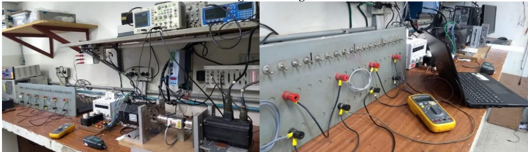
Figura 37: Ensaio de gerador sob carga. (a) bancada com cargas resistivas. (b) detalhamento da ligação em triângulo das cargas.
