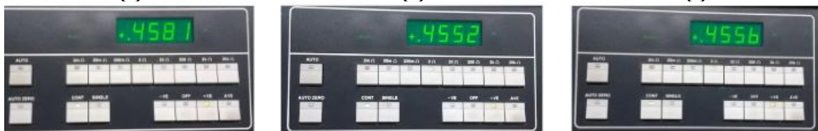
Figura 34: Ensaio de reatância síncrona para as 3 fases do gerador em (a) fase A, (b) fase B, (c) fase C.
