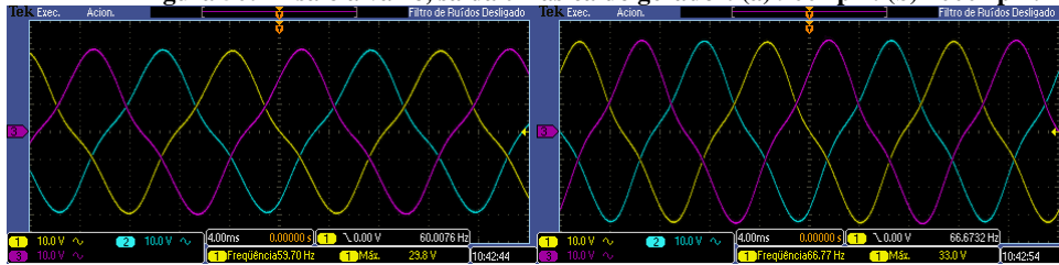
Figura 50: Ensaio a vazio, saída trifásica do gerador. (a) 900 rpm. (b) 1000 rpm.
