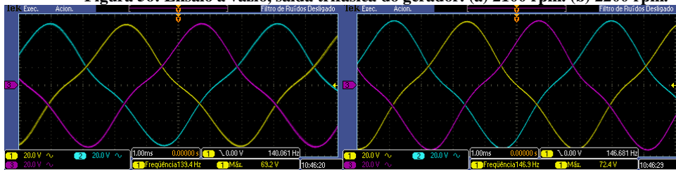
Figura 56: Ensaio a vazio, saída trifásica do gerador. (a) 2100 rpm. (b) 2200 rpm.
