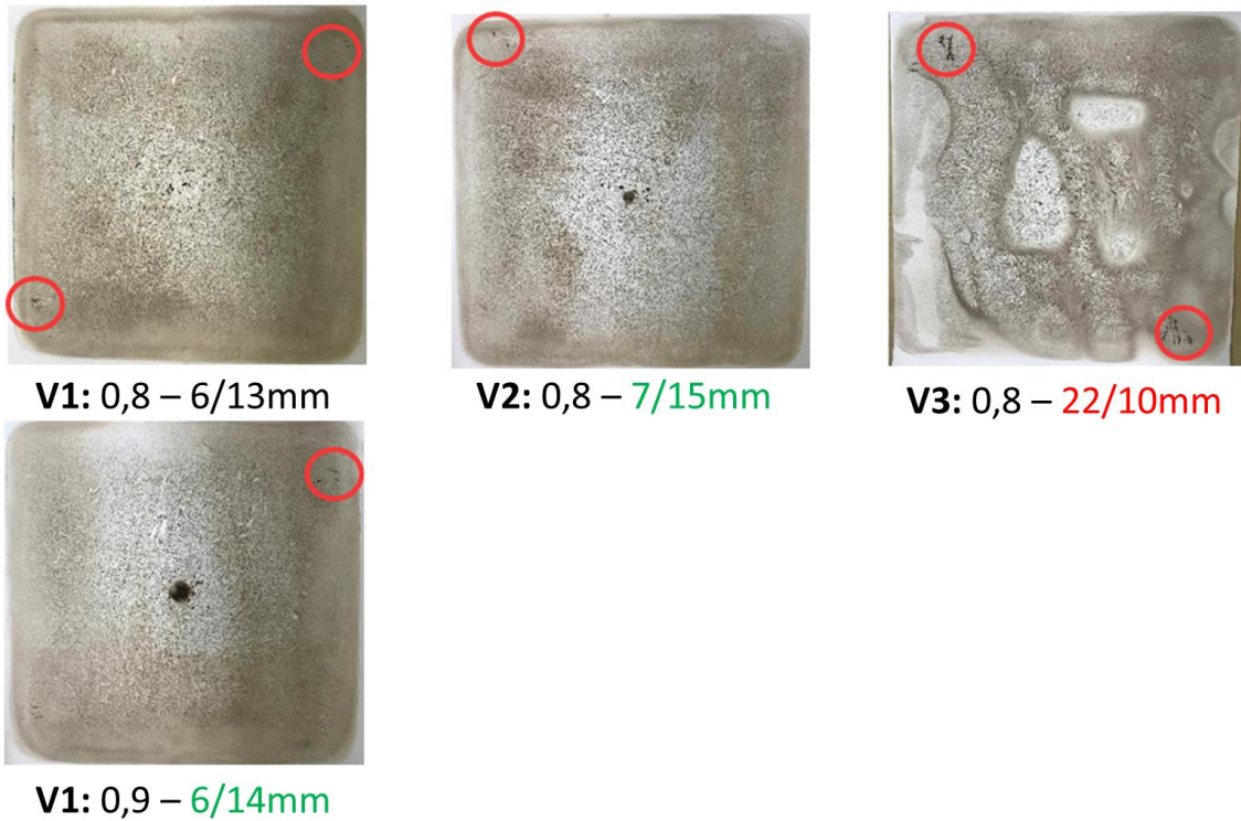
Figura 4.4 Resultados da corrida 4 com macrografias por veios, velocidades, tamanho/distância da superfície das TOCs.
