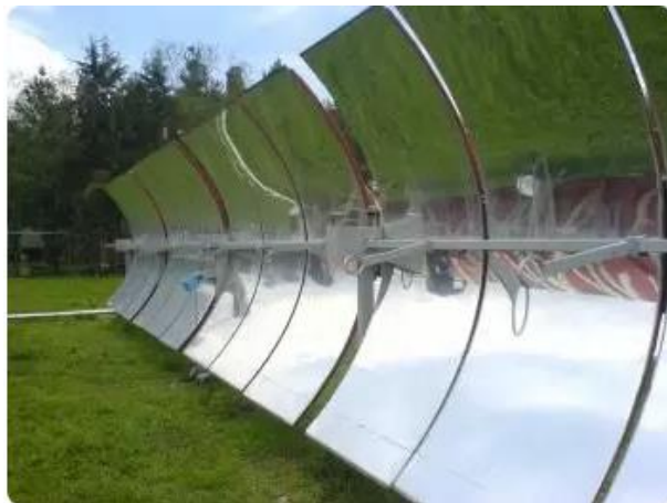
Figura 2 – Concentrador solar Parabólico.
