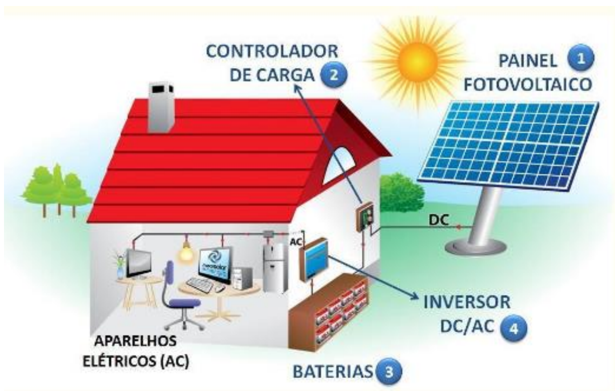
Figura 5 - Sistema autônomo isolado.
