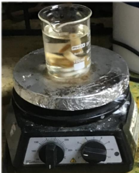
Figura 12 - Processo inicial de limpeza das ponteiros, sob aquecimento e agitação magnética.
