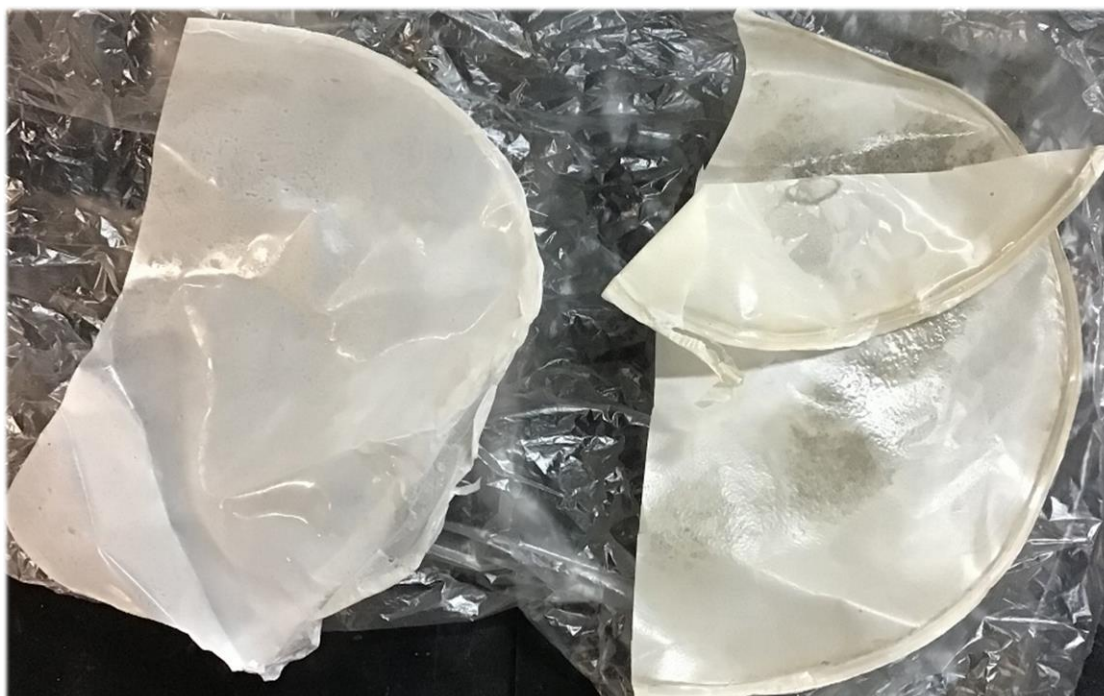
Figura 15 - Filmes ACV e ACR produzidos com adição de plastificante etilenoglicol.
