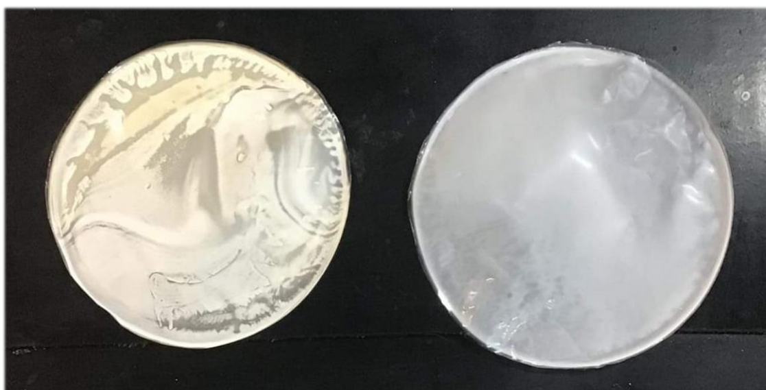
Figura 14 - Primeiros filmes tipo ACV e ACR gerados via Casting.
