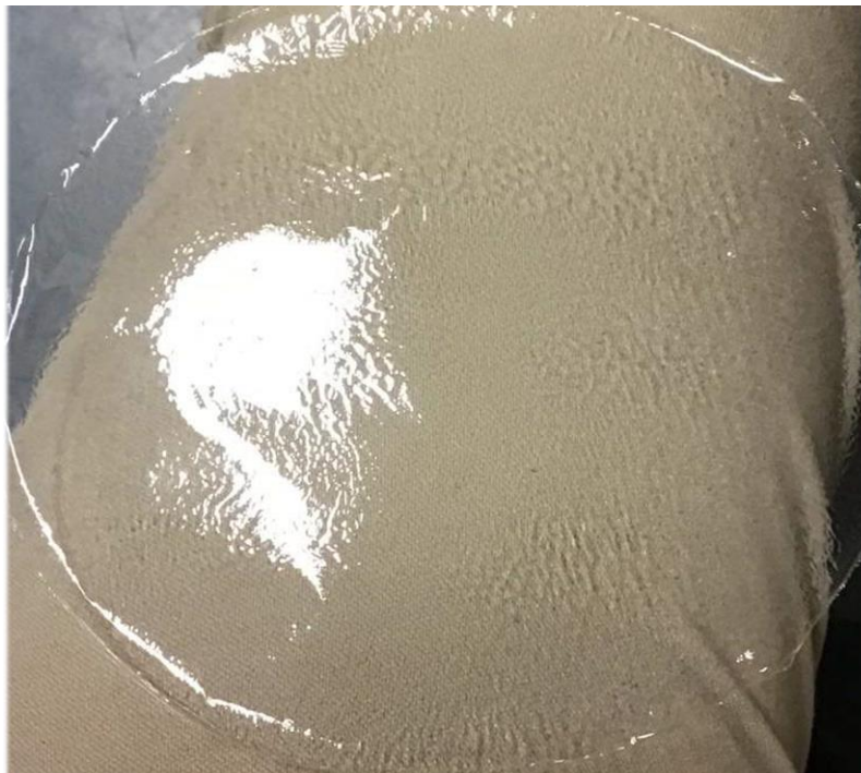
Figura 28 - Filme ACV produzido via Casting e seco em estufa, à temperatura de 55°C.
