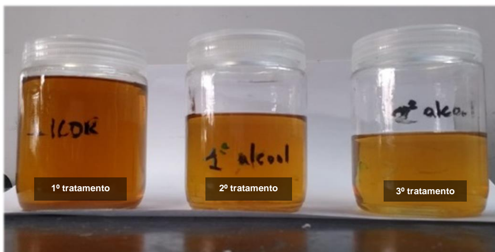
Figura 25 – Efluentes gerados logo após tratamento de limpeza com álcool.
