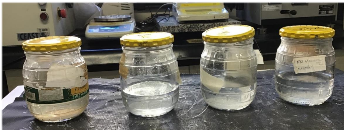
Figura 17 - Recipientes contendo as amostras para ensaio de umidade, em umidade relativa próxima à 75%.
