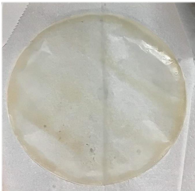
Figura 16 - Filme ACR produzido com adição de plastificante etilenoglicol.
