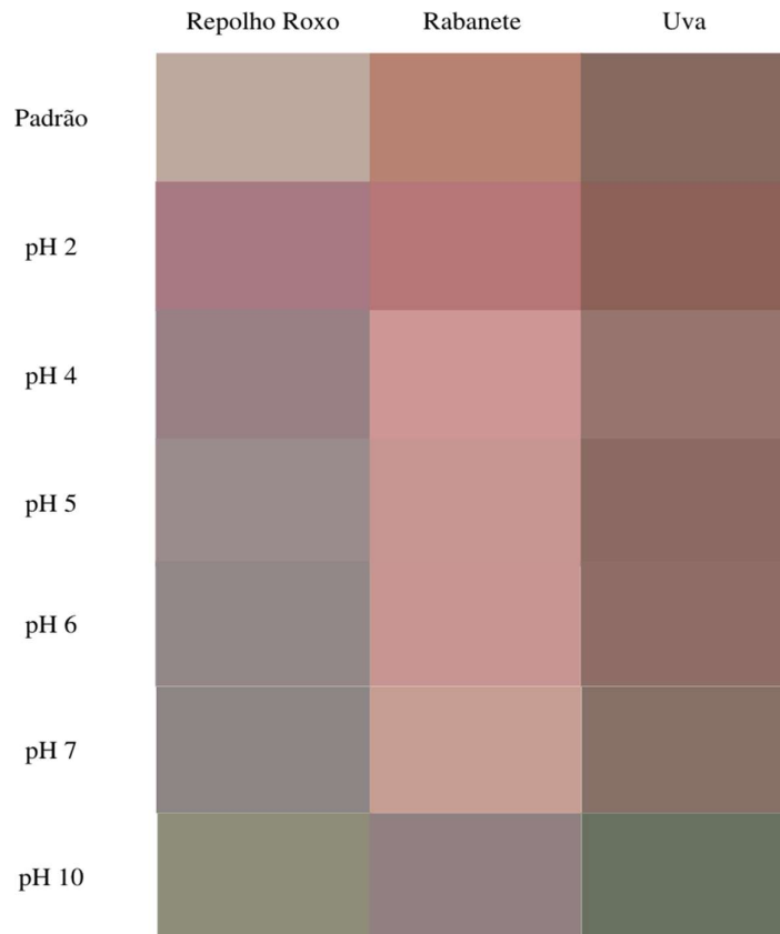
Figura 21 - Simulação da cor dos filmes com diferentes fontes de antocianinas na faixa de pH 2 a 10.
