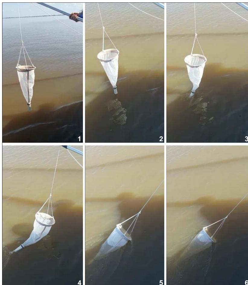
**Figura 9.** Passo a passo do procedimento de coleta de água superficial do Lago Guaíba por meio arraste horizontal da rede de zooplâncton.
