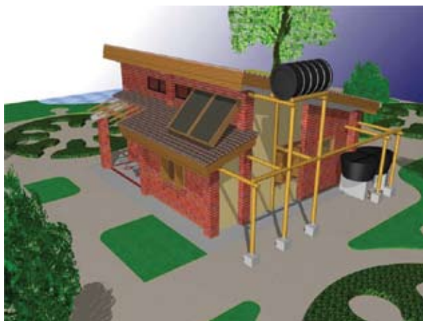
Figura 50 – Sistema de coleta de água de chuva
