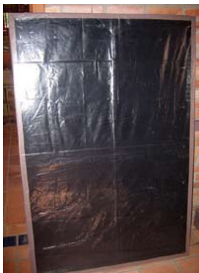
Figura 237 – Placa coletora com lona plástica
