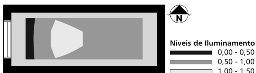
Figura 203 – Simulação da distribuição da iluminação natural no interior do banheiro no projeto proposto
