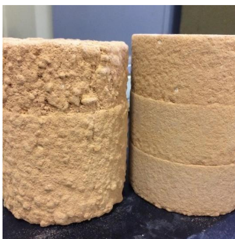
Figura 4.24: Corpos de prova de maior perda de massa (PMA = 19,37%) e menor perda de massa (PMA = 2,18%) ao final do 12º ciclo, respectivamente
