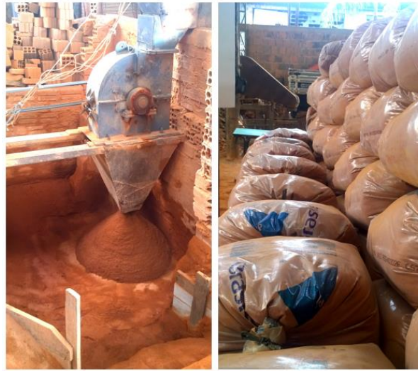
Figura 3.3: Processamento no moinho de martelos (esquerda), estocagem no material na empresa Graniplast (direita).
