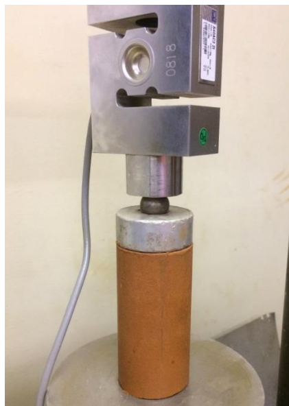
Figura 3.14: Ensaio de resistência à compressão simples
