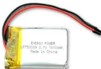
Figura 22 - Bateria para alimentar o receptor GNSS EMLID Reach M2
