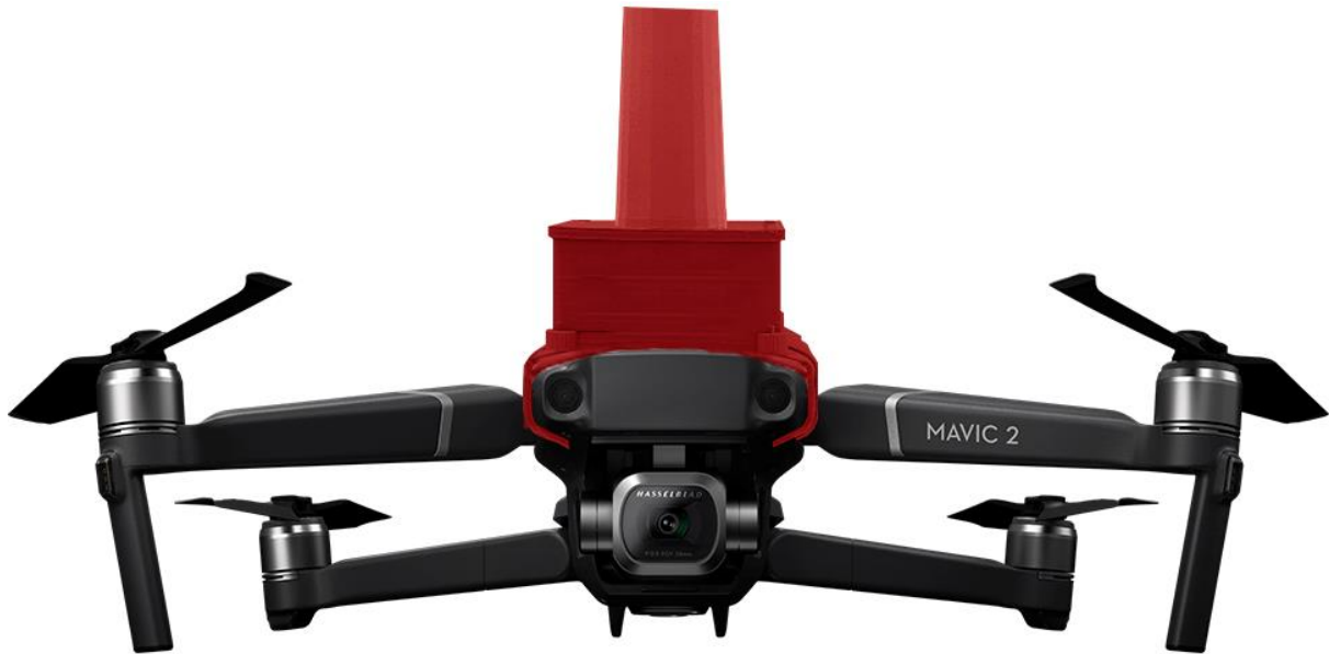
Figura 27 - Suporte de fixação do receptor e da antena.
