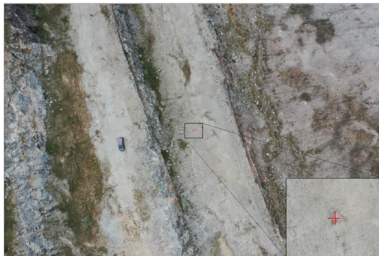
Figura 40 - Imagem mostrando o alvo virtual centrado, criado de forma automática
