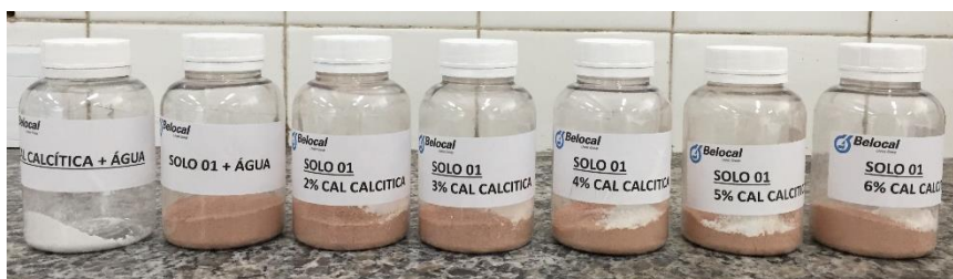
Figura 3.5: Potes com amostras de solo e cal para realização do ensaio do método do pH
