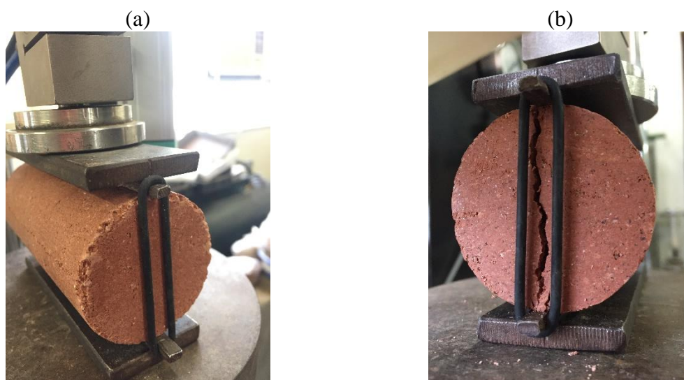
Figura 3.7: Ensaio de resistência à tração por compressão diametral: antes (a) e depois da ruptura (b)
