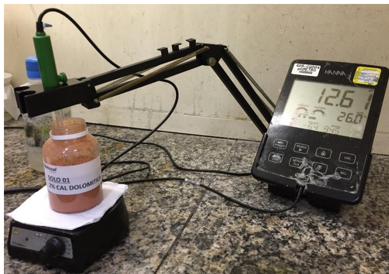
Figura 3.6: Leitura do pH para dosagem de solo-cal
