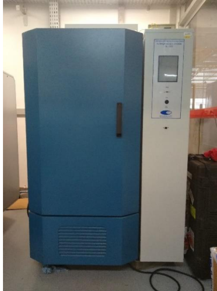
Figura 28 – Câmara Climática utilizada nos ensaios de variação de temperatura. Fonte: Elaborado pelo autor.
