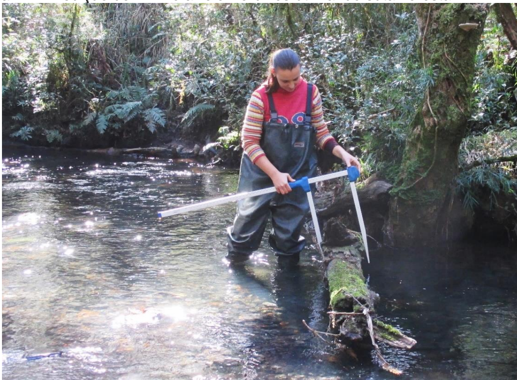
Figura 27 – Medição de LW no arroio Perdizes utilizando suta florestal.
