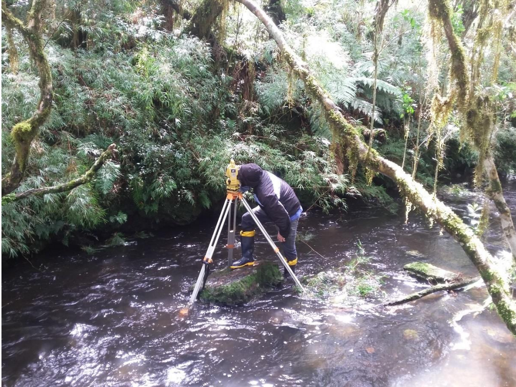
Figura 18 - Levantamento topográfico do arroio Perdizes utilizando Estação Total.
