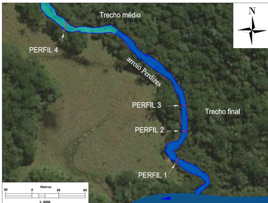
Figura 21 - Perfis transversais utilizados para medição da velocidade média sob diferentes níveis.
