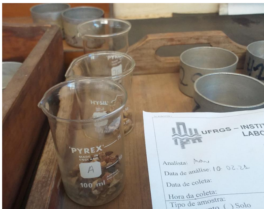
Figura 25 – Separação e análise dos sedimentos arenosos no LabSed-IPH (UFRGS).
