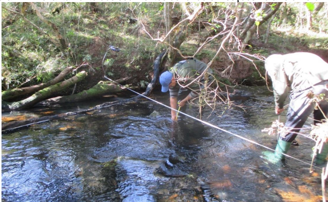
Figura 24 – Levantamento dos sedimentos de fundo em seções no arroio Perdizes.
