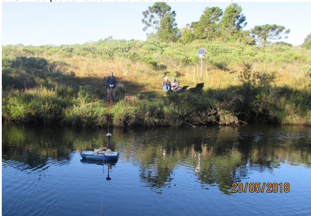
Figura 15 - Medição de vazão no rio Perdizes utilizando ADCP.
