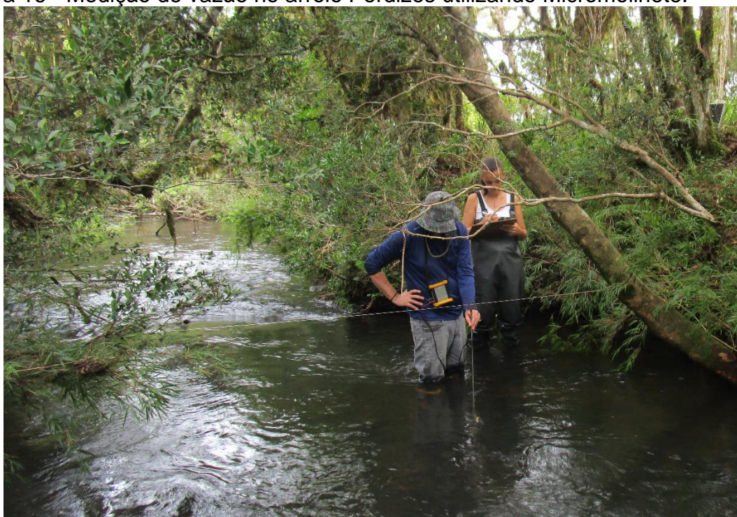
Figura 16 - Medição de vazão no arroio Perdizes utilizando Micromolinete.
