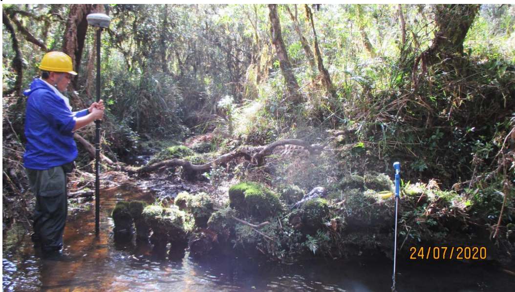
Figura 30 - Demarcação do LW com GPS RTK, no ponto a montante em relação ao fluxo.
