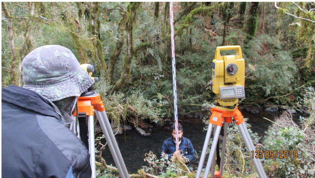
Figura 20 - Monitoramento de seção transversal demarcada com estaca no arroio Perdizes.
