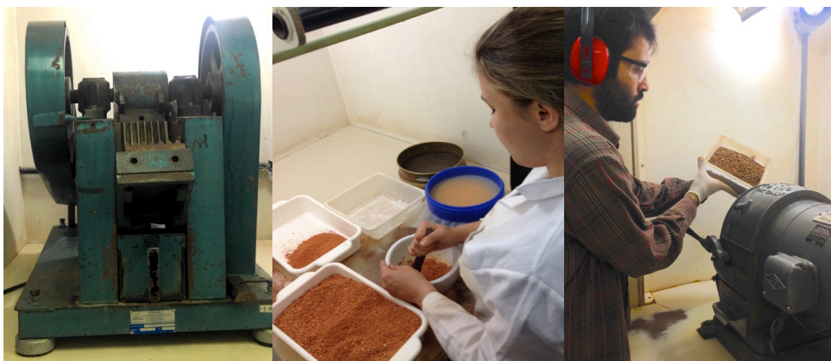
Figura 9 – Parte inicial de procedimentos para tratamento de amostras geocronológicas no PrepLab-CEPGq-UFRGS. Esquerda : Britador de amostras, tipo mandíbula, para moagem preliminar de rochas. Centro : Desagregação de nódulos das amostras em pistilo de madeira para posterior peneiramento manual. Direita : Cominuição do material maior que abertura da peneira em moinho de disco visando novo peneiramento.
