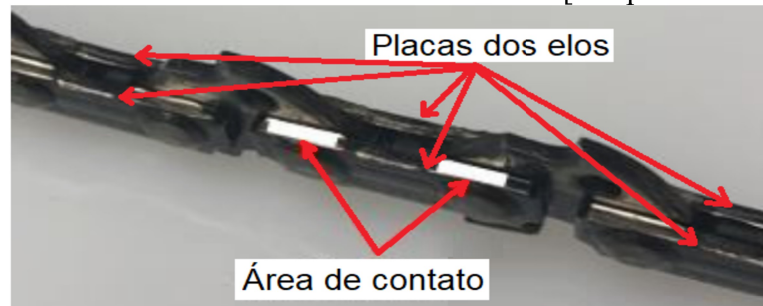
Figura 10 - Área de contato entre corrente e sabre. [Adaptado: Sellars (2021)]
