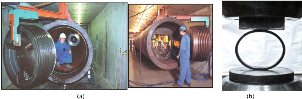
Figura 2 – (a) Câmara hiperbárica para o ensaio da pressão externa de colapso. (b) Prensa universal para o ensaio da força de colapso diametral.
