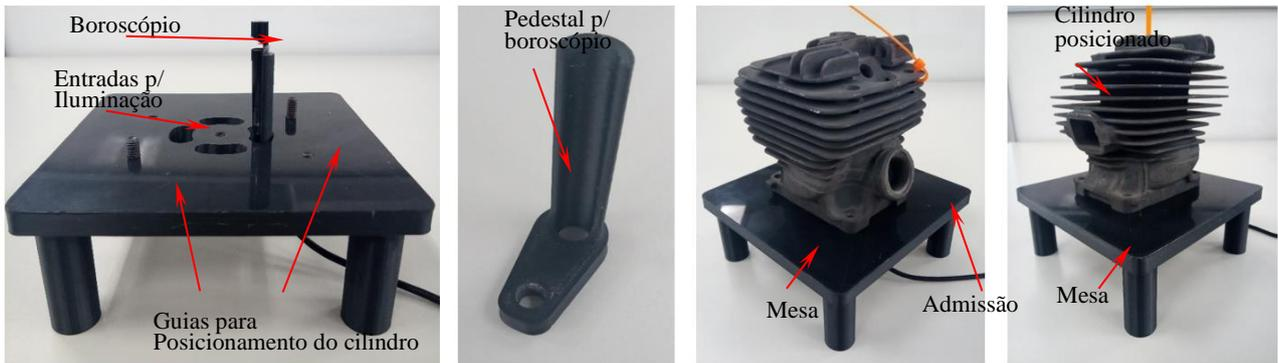
Figura 4.2 – Da esquerda para direita: Dispositivo de fixação, componente de posicionamento da câmera e cilindro posicionado no dispositivo de fixação. (Fonte: Autor).
