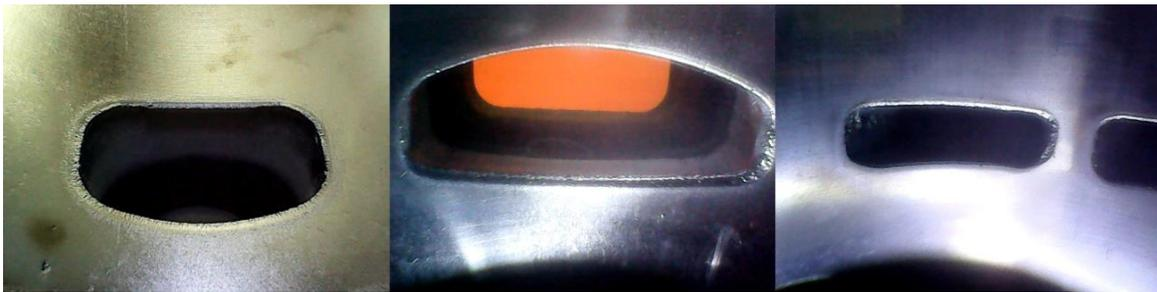
Figura 4.3 – Da esquerda para direita: imagem interna da janela de admissão, janela de escape e canais de transferência em diferentes configurações de posicionamento e iluminação. (Fonte: Autor).
