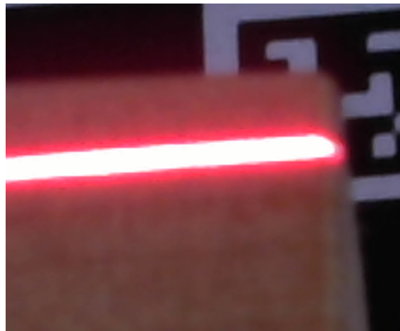
Figura 9: Detalhe de uma imagem mostrando o feixe laser. Captura realizada com ganho e tempo de exposição automáticos da câmera.
