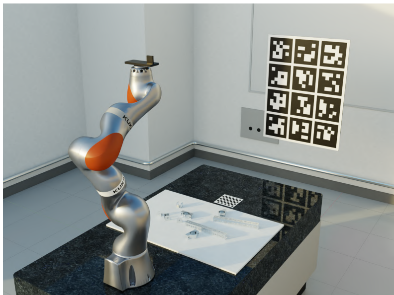
Figura 19: Cena utilizada para calibração Hand-eye com alvo ArUco.
