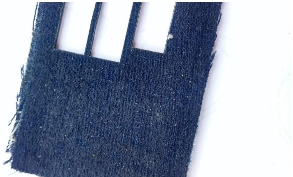
Figura 25 - Compósito de resíduos têxteis e resina de poliéster.
