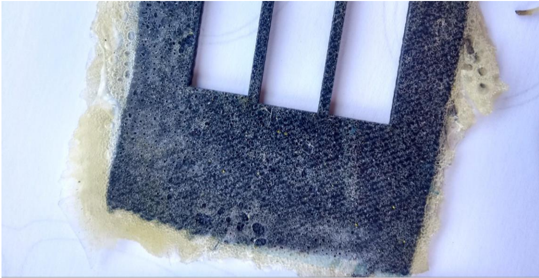
Figura 24 - Compósito de resíduos têxteis e resina PU vegetal.
