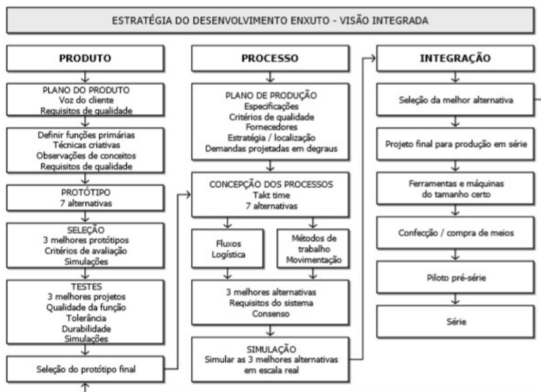
Figura 5 - Visão integrada do desenvolvimento de produto (fonte: Schramm, 2004)
