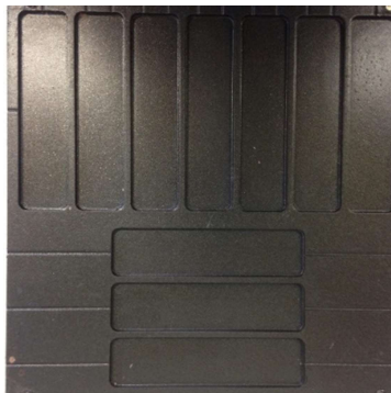
Figura 2: Molde metálico com revestimento antiaderente em teflon utilizado para produção das espumas.
