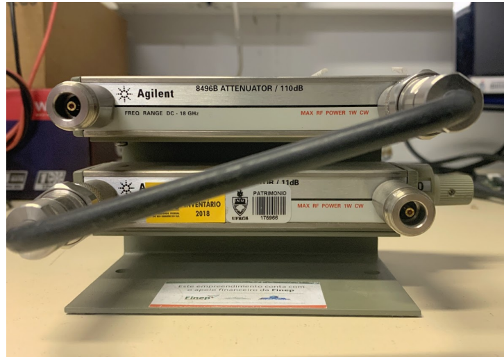
Figura 22 – Atenuadores 8496B e 8494B ligados em série por uma ponte coaxial.
