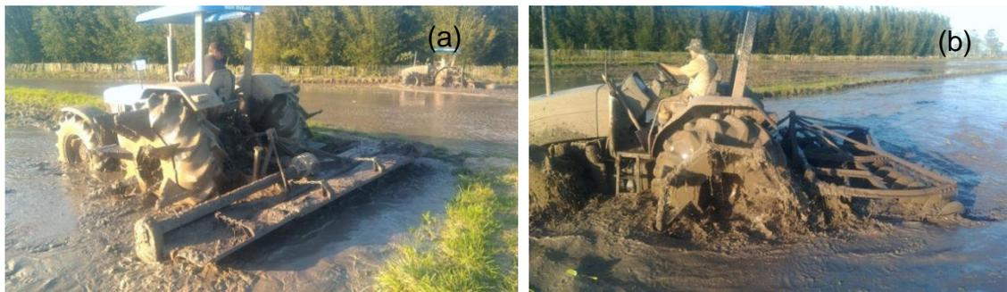
**Figura 5.** Preparo do solo a) Enxada rotativa b) Grade hidráulica.
