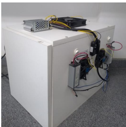
Figura 24: (a) Reator fotoquímico utilizado no desenvolvimento do trabalho (b) Ilustração do procedimento experimental.
