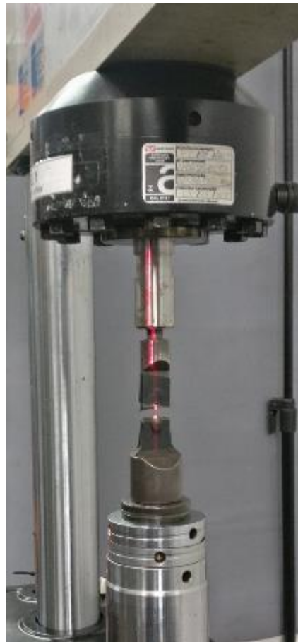
Figura 32 - Ensaio de micro-amostra monitorado por extensômetro a laser
