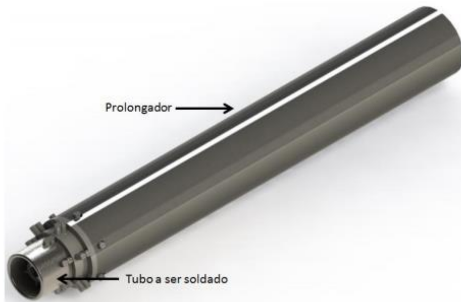
Figura 27 - Sistema de encaixe para posicionar o tubo
