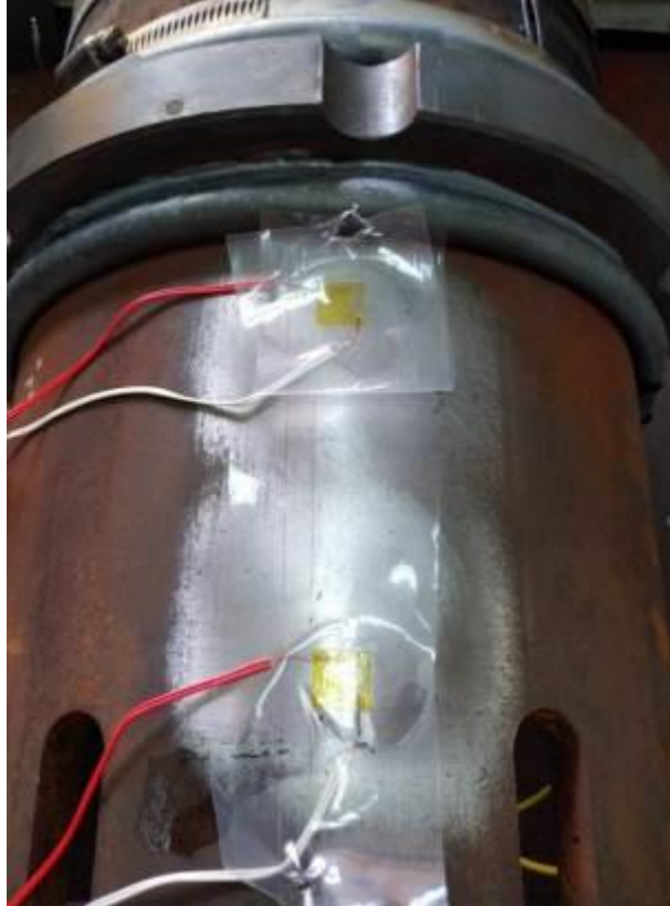
Figura 28 - Posição dos extensômetros
