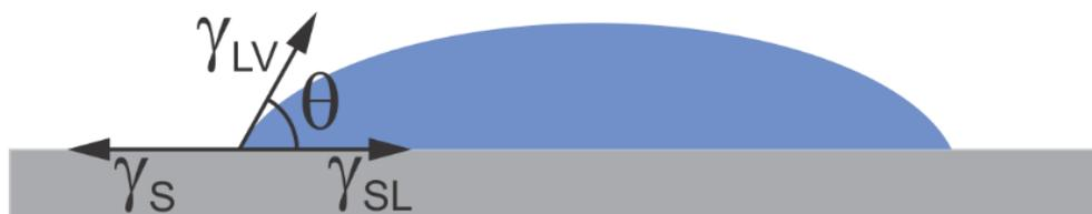
Figura 18: Definição do ângulo de contato. (Adaptado de [60]).
