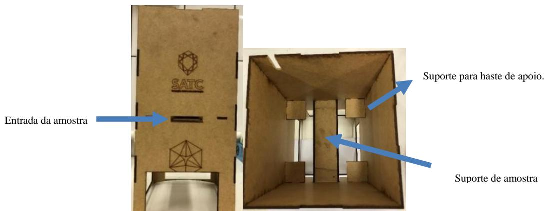
Figura 32: Dispositivo criado para evitar exposição aos LEDs contendo em (a) Visão externa; (b) Visão superior.
