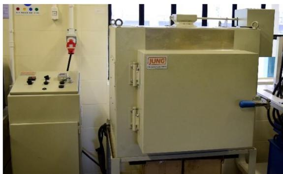
Figura 25: Forno tipo mufla com atmosfera sem controle.
