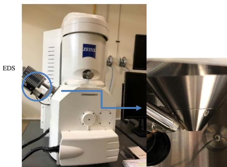
*Figura 29: Espectrômetro de Raios X, por energia dispersiva (EDS) Modelo EDX-7000 da marca Shimadzu utilizando nos experimentos com detalhe do EDS .*
