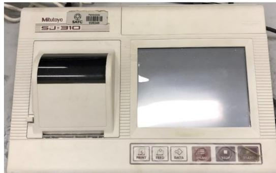
Figura 27: Rugosímetro utilizado para os experimentos Mitutoyo SJ-310 com resolução de  $0,65\mu\text{m}$ .
