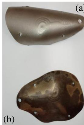
Figura 47: Comparativo das amostras *As Received* e Tratada Termicamente a  $595^\circ\text{C}$ .
