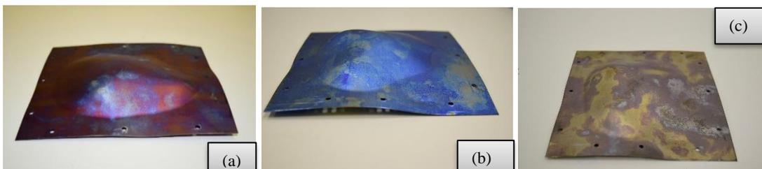
Figura 38: Amostras após tratamento térmico: (a) Amostra 1 com temperatura de 480° C. (b) Amostra 2 com temperatura de 540° C. (c) Amostra 3 com temperatura de 595° C.
