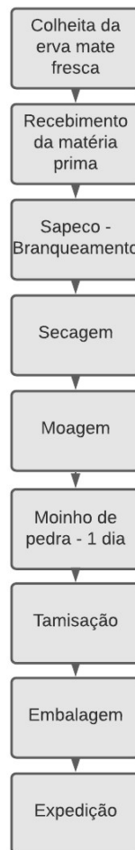
Figura 2. Diagrama de blocos do processo produtivo do matchá de erva-mate realizado pela empresa Inovamate.
